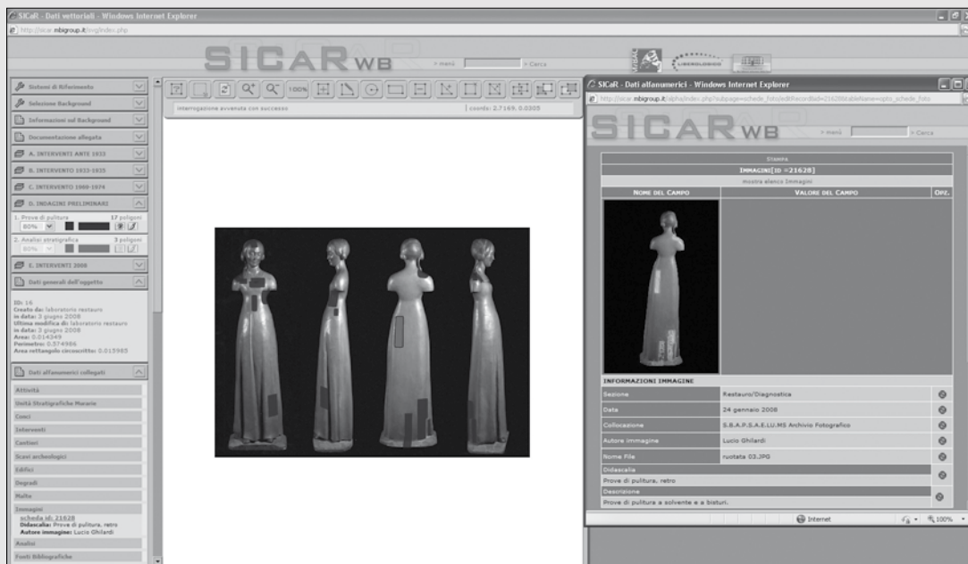
Annunziata di Camaiore (LU). Esempio di mappatura su base fotografica. L'interrogazione mostra le fotografie dei tasselli di pulitura georeferenziate sul sistema di riferimento.
