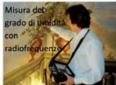
Misura del grado di umidità con radiofrequenze
